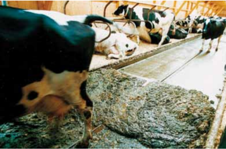
Şekil 10.4 Katlamalı sıyrıcı çalışma sırasında [4]
